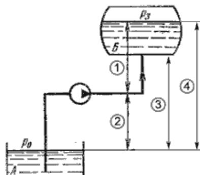
Геометрическая высота нагнетания на рисунке
